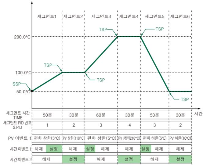
각 세그먼트의 TSP(달성 목표 설정치), TIME(세그먼트 시간 설정), S.PID(세그먼트 PID 번호 선택) 파라미터의 표시 기호는 같습니다. 단 기호 표시에 세그먼트 번호가 나타납니다.
